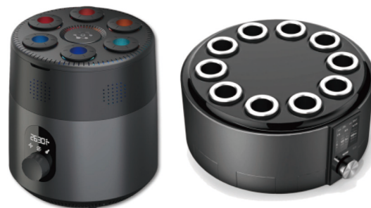
图 1 平行光反应器 AL (左) 和平行光反应器 AF (右)
